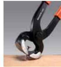
Tenazas: utilizadas principalmente para la extracción de clavos. También para cables de tamaño y dureza media.
